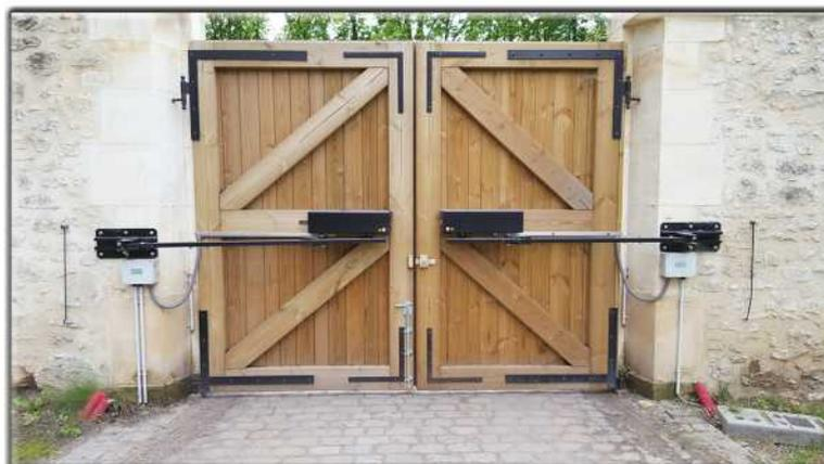
Les motorisations type « MEP 3 – MEP 5 - MEP 7 » sont composées d'un réducteur à couple conique et d'un moteur basse tension avec électronique intégrée.
